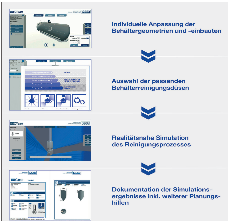
Abb. 3: Die Software TankClean simuliert am konkreten Beispiel der projektierten oder bestehenden Kundenanlage die Reinigungsaufgabe.
